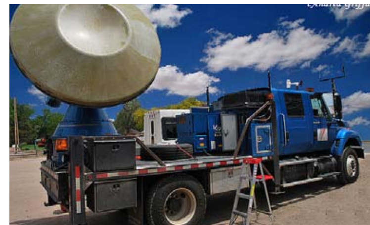
Doppler On Wheel, il veicolo col radar doppler portatile per studiare i temporali e tornado
